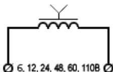
**3.3** Ниже приведена электрическая схема счетчиков, работающих от переменного и постоянно-переменного тока
