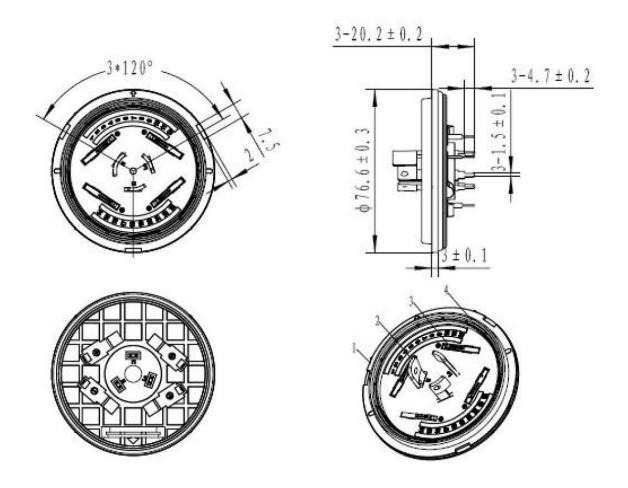
Материал корпуса: PBT (ПолиБутиленТерефталат), UL 94-V0.
