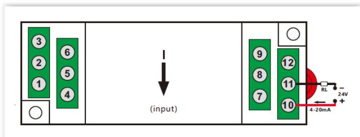
Сквозной токовый вход, клеммы 1-6,7-9 и 12 – не используются (нет соединения),
