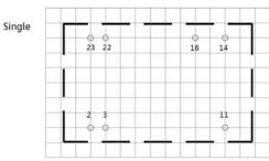
Pin-Out Single Pin Dual 2,3 GND GND No Pin 0٧ 9 11 NC -Vo 14 +Vo +Vo 16 ov OV 22.23 Vin Vin
