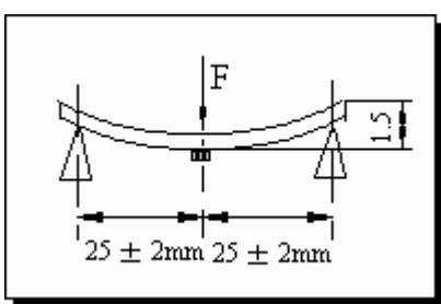
将产品按图焊在  $1.6 \pm 0.2$ mm 的 PCB 板中间，由箭头方向施力：1mm/S，弯曲距离：1.5mm，保持  $5 \pm 1$ S，产品金属层无脱落。
