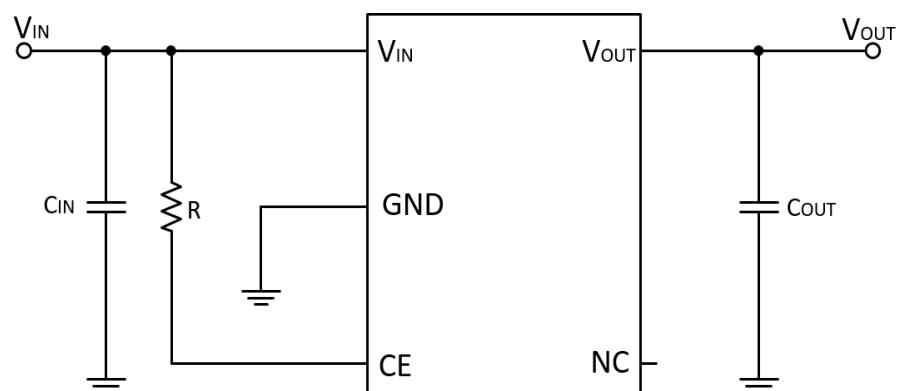
Note1:Input capacitor  $C_{IN}=1\mu F$ .
